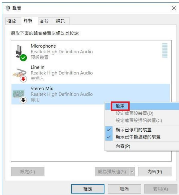
4. 如果錄音軟體內沒有“立體聲混音 Stereo Mix”選項可以選擇，請將“立體聲混音 Stereo Mix”在系統錄製設定視窗內設定成預設裝置。
