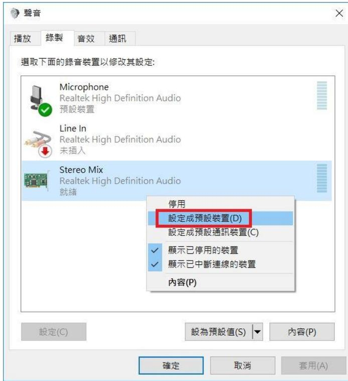
5. 開啟錄音軟體並將“立體聲混音 Stereo Mix”設定成錄音裝置。
